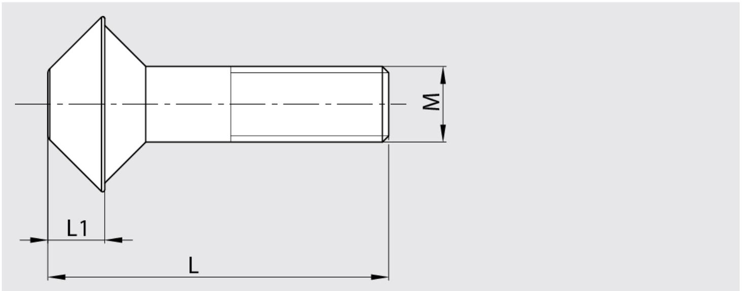
Maße Spannzapfen-Schrauben für Nullpunktspannsystem ZPS
