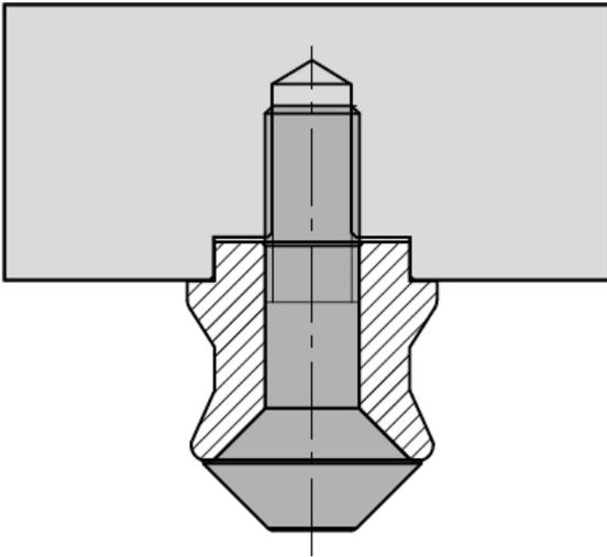
Montage mit Spannzapfen-Schrauben für Nullpunktspannsystem ZPS
