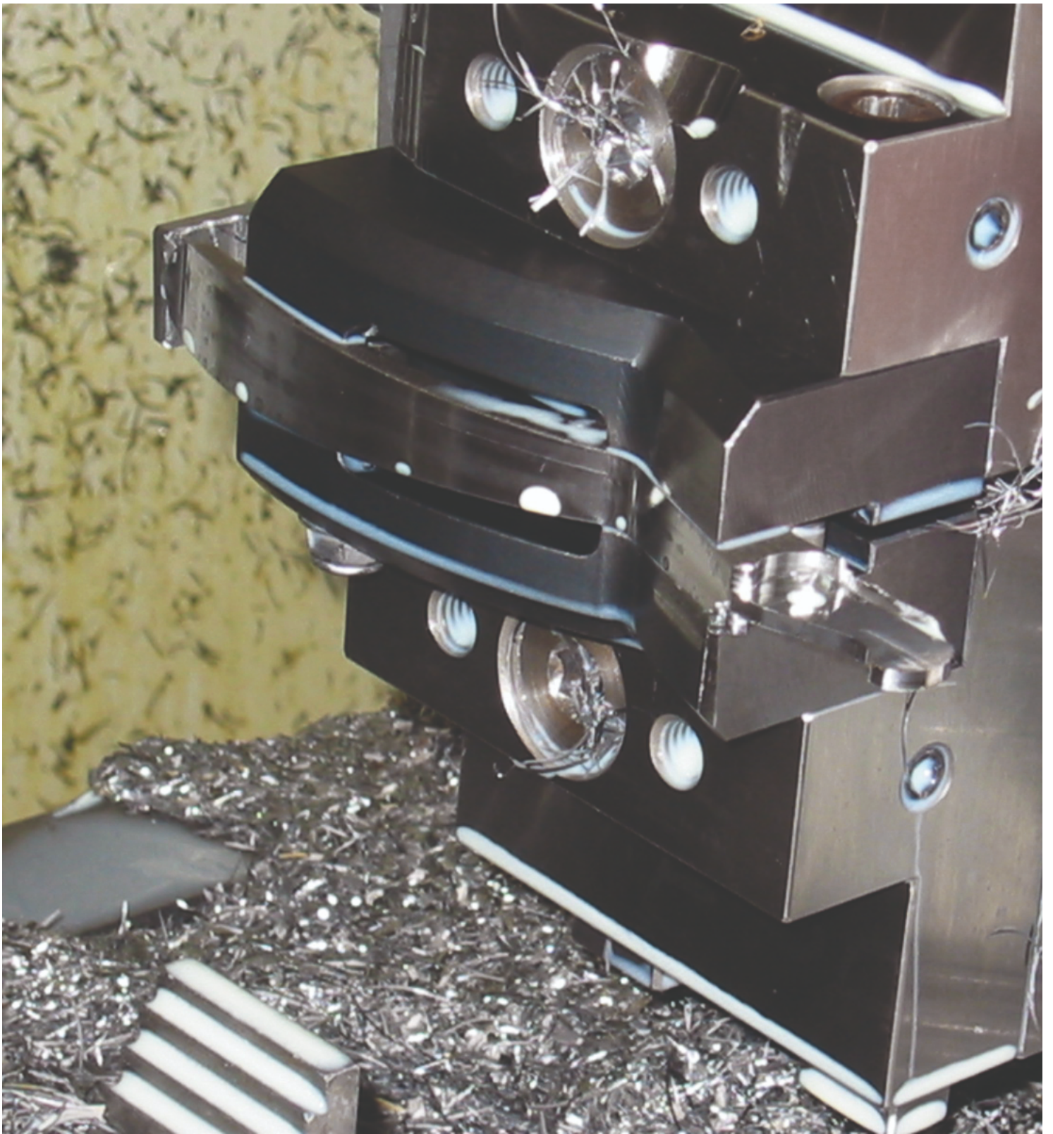
Mechanischer Zentrischspanner MZZS 180-80 B mit Sonderbacken
